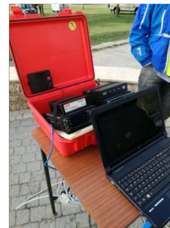
Stazione PACTOR composta da ricetrasmittitore, modem e accordatore d’antenna
