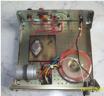
fornisco anche schema e vista d'assieme, ricordando come avessi cercato allora di ridurre al massimo l'altezza usando un trasformatore toroidale e idonea componentistica.
