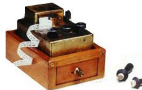
Prima generazione di perforatore manuale di banda, Wheatstone, con punzone di perforazione, 1870
