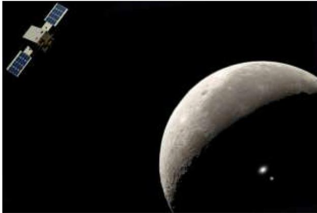
Il Lunar Volatile and Mineralogy Mapping Orbiter di 12 unità mapperebbe i minerali di superficie lunare ed i gas congelati come l'acqua ghiacciata ad una risoluzione di 10 m, usando un "radar laser" per sbirciare nelle regioni in ombra ai poli.
