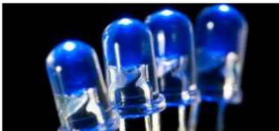
I LED blu furono sviluppati per la prima volta da Herbert Paul Maruska, alla RCA, nel 1972, usando il Nitruro di Gallio su un substrato di Zaffiro. I LED di tipo SiC
