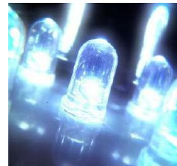
renti elettriche creano livelli di calore più elevati, che possono compromettere la durata dei LED. A causa di questo aumento di calore a correnti più alte, i LED ad alta luminosità hanno uno standard industriale di funzionamento a soli 350 mA, che è un compromesso tra emissione luminosa, efficienza e longevità.
