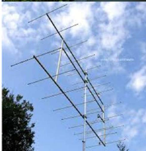
Gli elementi parassiti assorbono e riattivano le onde radio dall'elemento condotto con una fase diversa, modificando il pattern di radiazione del dipolo. Le onde degli elementi multipli si sovrappongono e interferiscono per migliorare la radiazione in un'unica direzione, ottenendo un aumento sostanziale del guadagno dell'antenna rispetto a un semplice dipolo.
