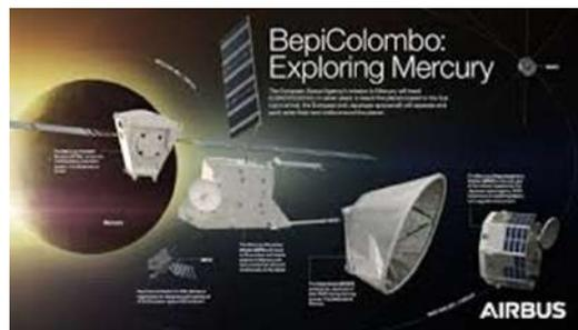
L'array solare richiederà una rotazione continua mantenendo il Sole ad un angolo di incidenza basso, al fine di generare una potenza adeguata e allo stesso tempo limitare la temperatura.
