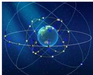
Il sistema di navigazione satellitare BeiDou è un sistema cinese e consiste di due costellazioni satellitari separate. Il primo sistema BeiDou, ufficialmente chiamato BeiDou Satellite Navigation Experimental System e noto anche come BeiDou-1, è composto da tre satelliti che dal 2000 offrono una copertura limitata e servizi di navigazione, principalmente per gli utenti in Cina e nelle regioni limitrofe. BeiDou-1 è stato dismesso alla fine del 2012.
