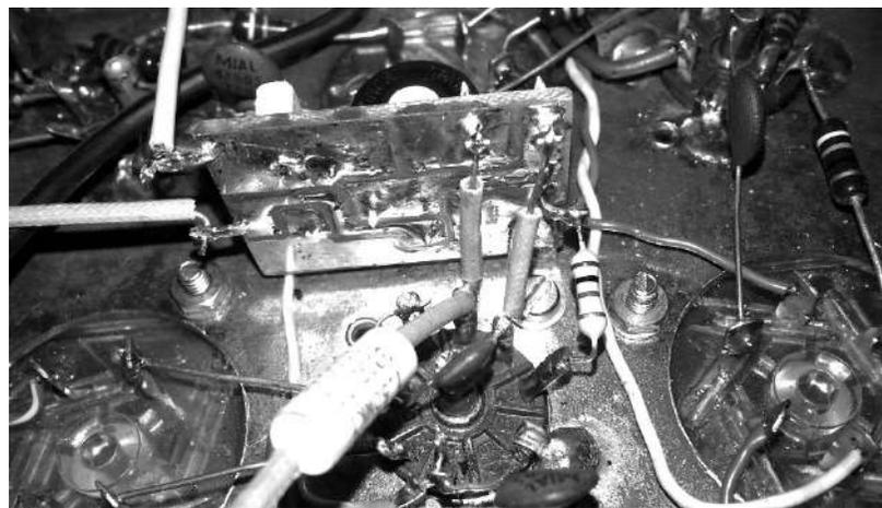
elettrica della radio va effettuata in assenza di corrente 220 V. I condensatori elettrolitici per l'alimentazione delle valvole sono ad alta tensione (800 - 1.000 V) e vi è pericolo di forti scosse anche ad apparato spento. I condensatori elettrolitici di alimentazione valvole, mantengono una carica cadauno di 500 V. È necessario scaricare a massa con filo adeguato la tensione rimanente nei condensatori.
