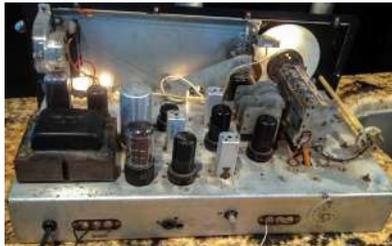
Il telaio superiore è stato pulito il più possibile. Non è perfetto, ma più pulito di prima. Ora abbiamo circa 110 V applicati attraverso il Variac. Niente fumo, ma abbiamo le luci!
