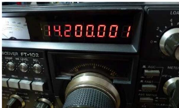
La sostituzione del lettore di frequenza nello Yaesu FT-102 è solo una delle modifiche che comprendono anche: filtro RF, filtri IF, Clarifier, AGC . Andrò per gradi facendo un passo
