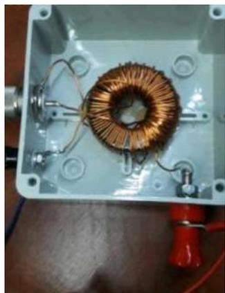
unun T-200 Amidon con un rapporto 1:160: in pratica sono riuscito ad avvolgere un cavo sottile di rame compiendo circa 160 cerchi. Questo mi darà la possibilità di attenuare del 90% il segnale ricevuto e di scendere di frequenza anche molto al di sotto dei 150 kHz. Allo stato attuale l'ho
