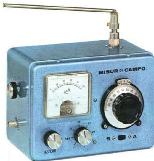
l'indice dello strumento a fondo scala; ora, senza più toccare niente, si fa girare l'antenna trasmittente lungo i 360° e si annotano per i vari angoli di spostamento i relativi valori di intensità di campo rilevati.
