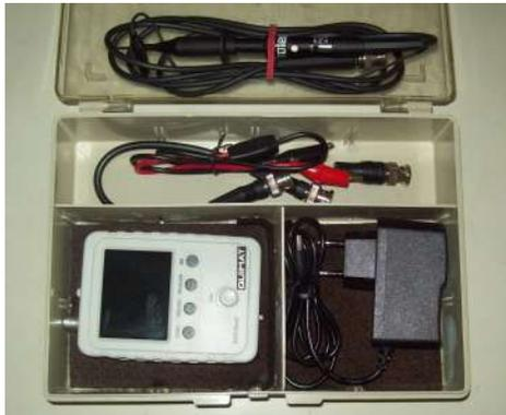
La confezione contiene lo strumento, l'alimentatore ed un cavetto con due coccodrilli a cui è bene aggiungere un altro BNC-BNC ed un probe x1-x10. (Figura a lato).
