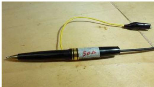
accorgiamo quando ci arrivano le caratteristiche dettagliate) è che nella posizione X1 la frequenza massima di utilizzo è di 8 MHz nel migliore dei casi; il dato di 100, 200 o 300 MHz è
