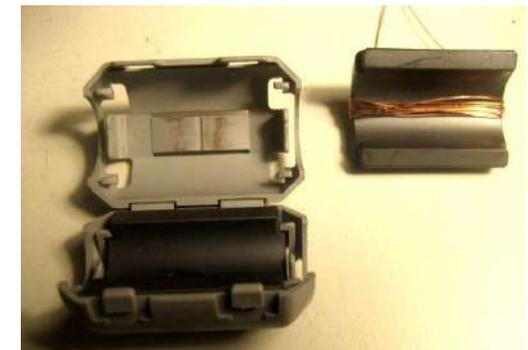
Naturalmente è possibile utilizzare altri tipi di ferrite, come la FT140-43 impiegata nello strumento nella Foto di apertura. In tal caso, essendo il toroide non apribile, saranno possibili misure so-
