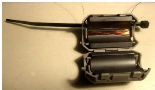
loro massa aumenta la perturbazione che lo strumento causa quando è usato per misurare le correnti in antenna. La sonda può essere fissata al contenitore usando una fascetta infilata tra l'involucro pla-
