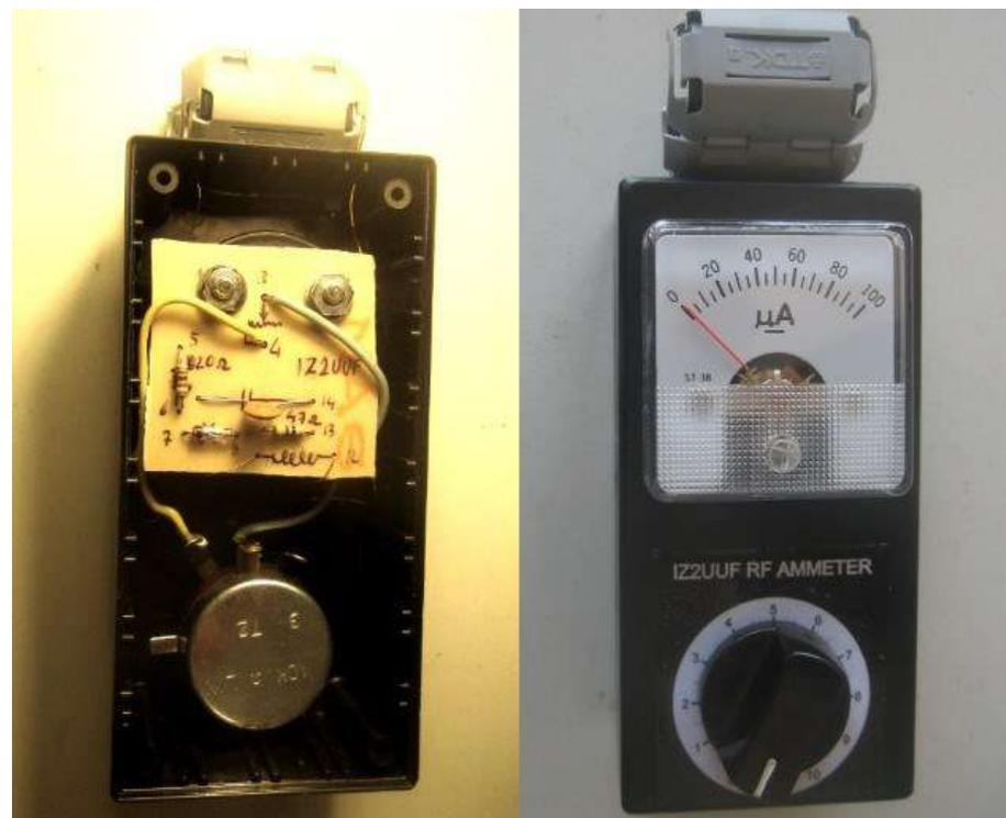
re l'effettiva corrente rilevata ed avere così anche un riscontro quantitativo. La calibrazione si esegue usando una corrente di riferimento la cui entità sia nota. La tecnica più semplice consiste nel prendere un corto coassiale terminato da due PL modificato in modo che, per un tratto di tre o quattro centimetri, calza e centrale viaggino su percorsi separati.
