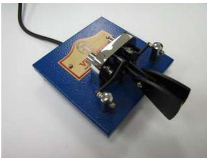
Pala lambica Standard Square Racer con base strutturata verniciata a polvere "Blue Racer Blue", cavo stereo 1/4" installato.
