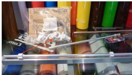
Un tubo di alluminio quadrato da 24 mm e un tubo di alluminio rotondo da 12 mm (verrà eventualmente sostituito da un tubo di rame della stessa sezione).
