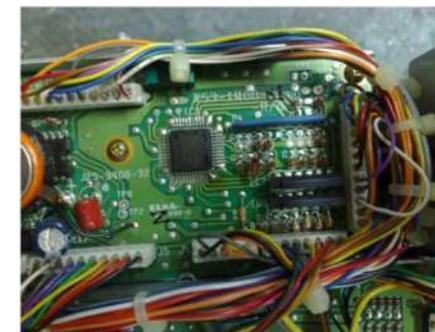
di non accavallare tra loro le saldature, pena la rottura dell'apparecchio. La Figura nella pagina successiva mostra una soluzione più che valida. Provvedere, a questo punto, a fissare la scheda nell'alloggiamento previsto con la vite in basso; non occorre alcuna taratura.
