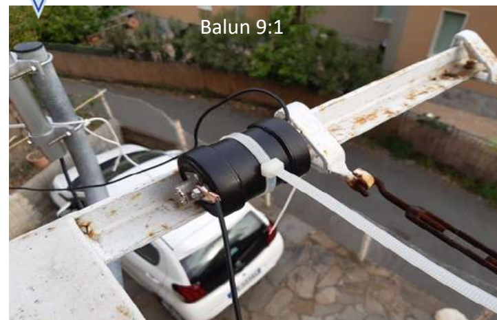
Filo di sostegno per mezzo dipolo filare
