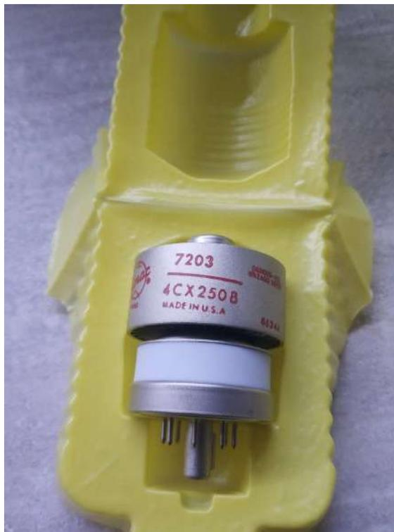
con 2.600 V di tensione eroga una potenza anche di 400 W e, come detto, è molto robusta. Un push-pull da 800 W dà risultati davvero molto buoni per l'attività di DX in 144 MHz.
