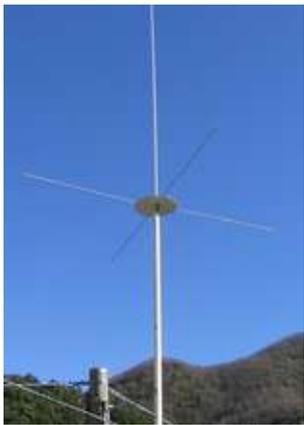
L'antenna è composta di un tratto di 4 metri che è stato svuotato e, quindi, è solo un tubo di vetroresina e un cimino di 3.10 metri che ha l'anima di silicone e, quindi, conduttore.
