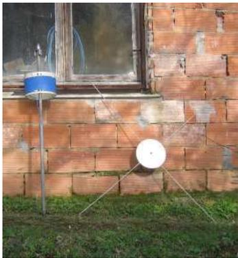
composta di 42 spire di cavo elettrico da 1.5 mm su un diametro di 250 mm e una lunghezza della stessa di 125 mm.
