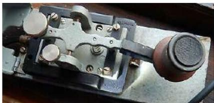
Si noti che il contatto posteriore non è collegato di base, ma è possibile aprire il tasto e collegarlo se necessario. Nelle Foto è possibile apprezzare i vari dettagli. La connessione avviene
