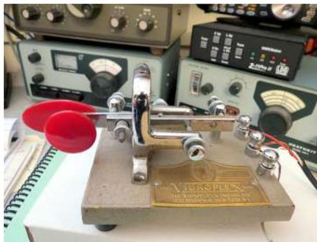
la produzione di un messaggio in codice pulito dall'Keyer elettronico al ricetrasmittente. Il vibrokeyer è stato a lungo lo standard per le DX-pedition per una trasmissione CW più veloce ed efficiente. La manopola e la disposizione dei vari componenti, che ricordano i tasti "bug",
