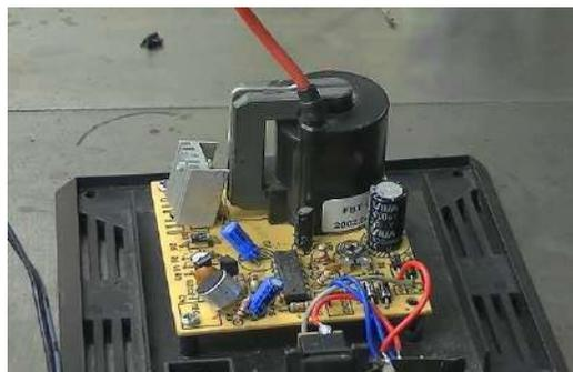
L'interno di una sfera al plasma commerciale, con il trasformatore flyback ben visibile
