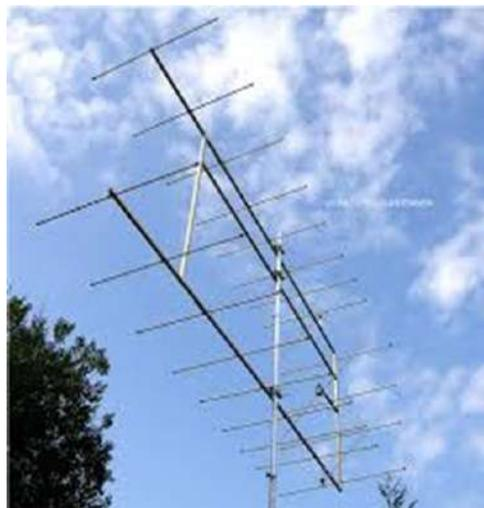
Gli elementi parassiti assorbono e riattivano le onde radio dall'elemento condotto con una fase diversa, modificando il pattern di radiazione del dipolo. Le onde degli elementi multipli si sovrappongono e interferiscono per migliorare la radiazione in un'unica direzione, ottenendo un
