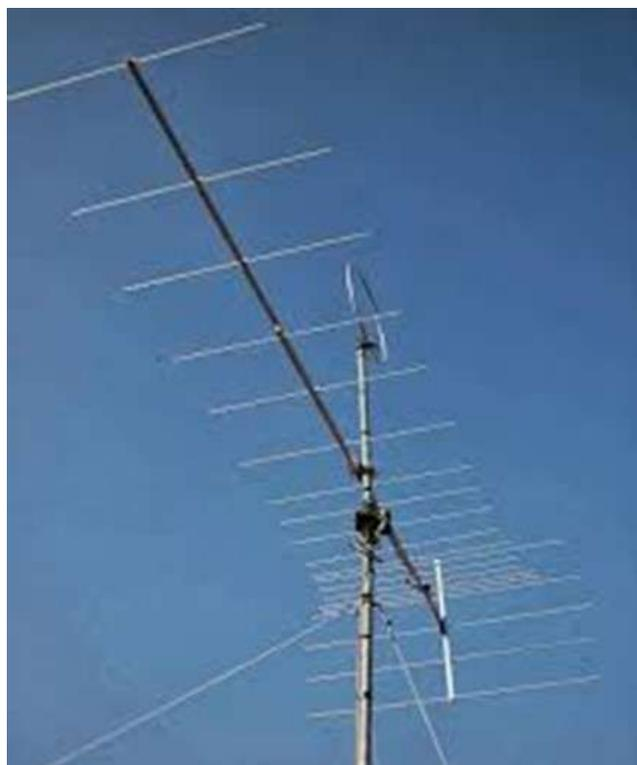
essere collegati a un supporto metallico conduttivo in quel punto senza bisogno di isolamento, senza disturbare il loro funzionamento elettrico. Di solito sono imbullonati o saldati al braccio di supporto centrale dell'antenna. L'elemento condotto è alimentato al centro, quindi le sue due metà devono essere isolate dove il braccio le supporta.
