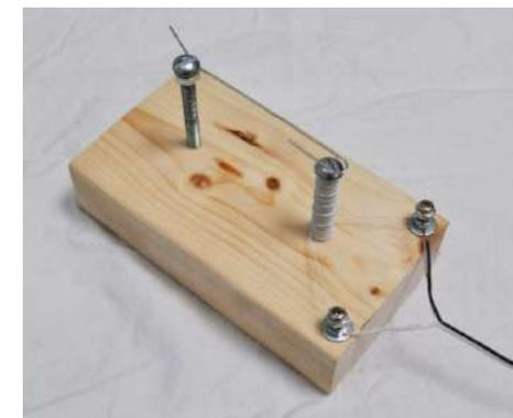
sospeso da un altro bullone per fungere da braccio sonoro (anche una lama per seghetto andrebbe benissimo). La distanza tra la graffetta e l'elettromagnete è solo di circa 1 mm (vedi Figura in alto a destra). I pali di collegamento sono costituiti da bulloni di ricambio avvitati direttamente nella base in legno, con dadi e rondelle per tenere i fili in posizione.
