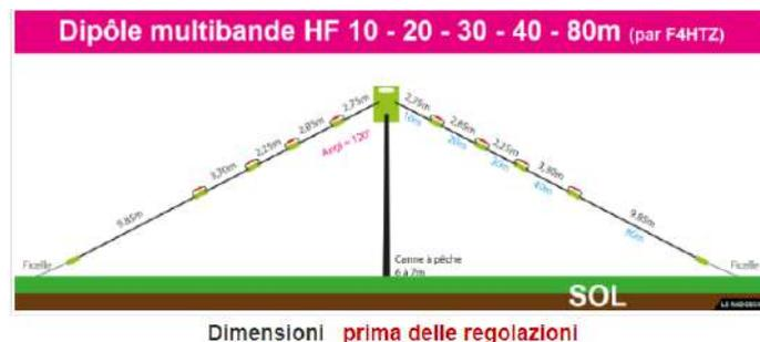
Questo dipolo cablato copre le principali bande radioamatoriali e ci consentirà di effettuare il traffico senza la necessità di utilizzare un tuning box. Avremo, quindi, un peso e un volume inferiori da portare nello zaino.
