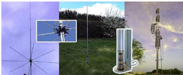
3/8 d'onda, 5/8 d'onda, 3/4 d'onda, 7/8 d'onda e full size (intera onda). I diagrammi di radiazione sono sempre gli stessi dell'antenna a quarto d'onda con un angolo di radiazione più o meno alto a seconda del tipo di GPA scelto.
