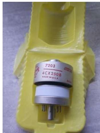
tati in tutte le bande d'impiego; con 2.600 V di tensione eroga una potenza anche di 400 watt e, come detto, è molto robusta. Un push pull eroga 800 watt, con risultati veramente molto buoni per il DX in 144 MHz.
