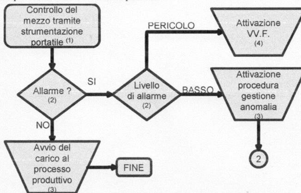
– Schema del flusso delle operazioni previste nella fase di sorveglianza radiometrica in ingresso effettuato per mezzo di strumentazione portatile
