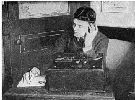
di ricezione radio dell'epoca non doveva convertire le onde radio in suoni come i ricevitori moderni, ma semplicemente rilevare la presenza o l'assenza del segnale radio. Il primo rivelatore ampiamente utilizzato è stato il Coherer, inventato nel 1890. Il Coherer era un rivelatore molto povero, insensibile e incline a falsi innesci a causa del rumore impulsivo, che ha portato allo sviluppo di molte ricerche volte a trovare rilevatori di onde radio migliori.
