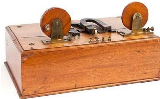
strumento di registrazione utilizzato nei ricevitori di radiotelegrafia, il registratore a nastro di carta sifone.
