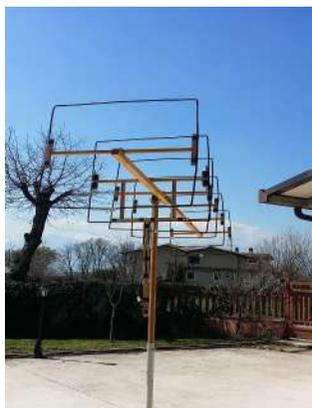
rosi. Per quanto riguarda il materiale utilizzato per la costruzione dei riflettore, del radiatore e dei direttori, ho utilizzato dell'alluminio da 4 mm ricoperto in pvc, recuperato presso un rottamatore della zona (probabilmente una bobina scartata dall'Ente per l'Energia Elettrica Nazionale, impiegata per le linee
