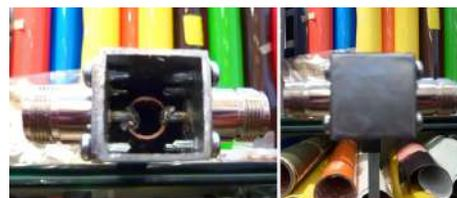
Fabrication d'un coupleur VHF pour un stack de 2 antennes VHF accordé sur 144300Mhz
