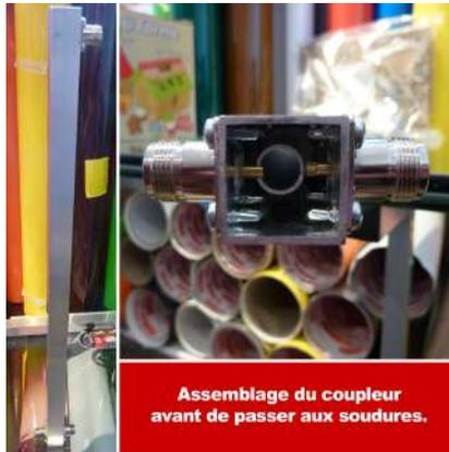
lato (lato interno) e un tubo rotondo di alluminio di 12 mm di diametro esterno (che alla fine ho sostituito con un tubo di rame della stessa sezione). L'accoppiatore è tagliato per la frequenza 144,300 MHz per 2 antenne di impedenza da 50 ohm e anche una linea di alimentazione da 50 ohm. L'accoppiatore utilizza la proprietà di trasformazione dell'impedenza delle linee di quarto d'onda.
