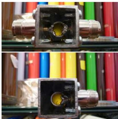
avere alla fine un risultato più professionale che ho sostituito il mio tubo di alluminio con un tubo di rame. Lì è più semplice realizzare le saldature.
